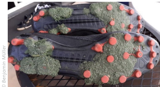
Verklumptes Kunststoffgranulat sowie hohe Oberflächentemperaturen und aufgeschwommenes Korkgranulat nach Wetterextremen auf Sportanlagen im Kölner Stadtgebiet.
